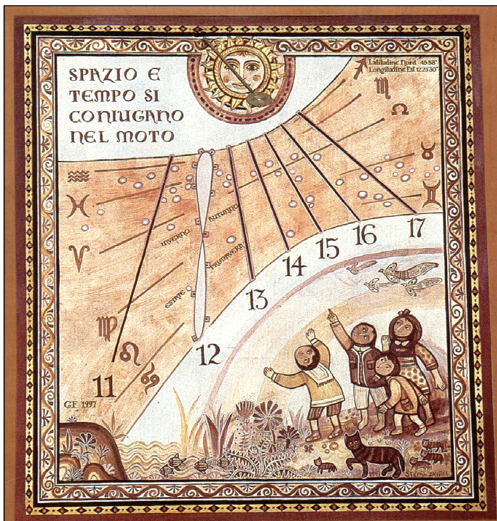
Figura 11. Meridiana a tempo vero del fuso (sulle ore 11, 13, 14, 15, 16, 17) e a tempo medio (sulle ore 12), realizzata sulla parete di una scuola elementare di Sarmede (TV) da Giovanni Flora. La foto è tratta da [3] .
